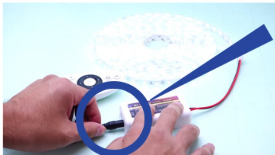
マルチゾーンコントローラーに供給する電源をONにする。
