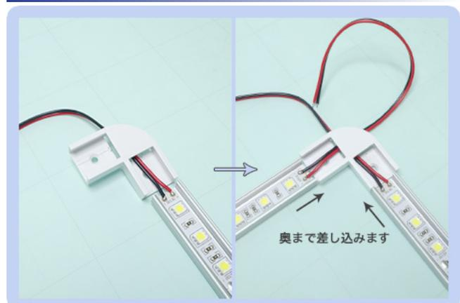
コーナーコネクタを使用してアルミフレームを接続します。このままだとスライドしてコーナーコネクタが外れやすいので接着剤などを使用することをお勧めします。
