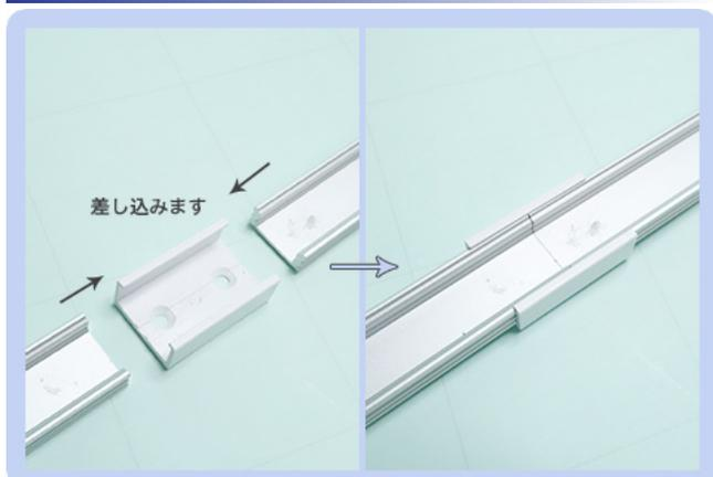
ストレートコネクタを使用してアルミフレームを接続します。このままだとスライドしてストレートコネクタが外れやすいので接着剤などを使用することをお勧めします。
