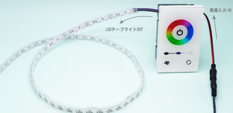
タッチパネルLEDコントローラーの入力側に電源を配線し、出力側にLEDテープライトを配線して下さい。コントローラー本体はDC12V-24Vをサポートしています。LEDテープライト12Vタイプを接続する場合はDC12Vの電源をコントローラーへ接続して下さい。LED製品の電圧に応じた電源をコントローラーへ供給して下さい。
