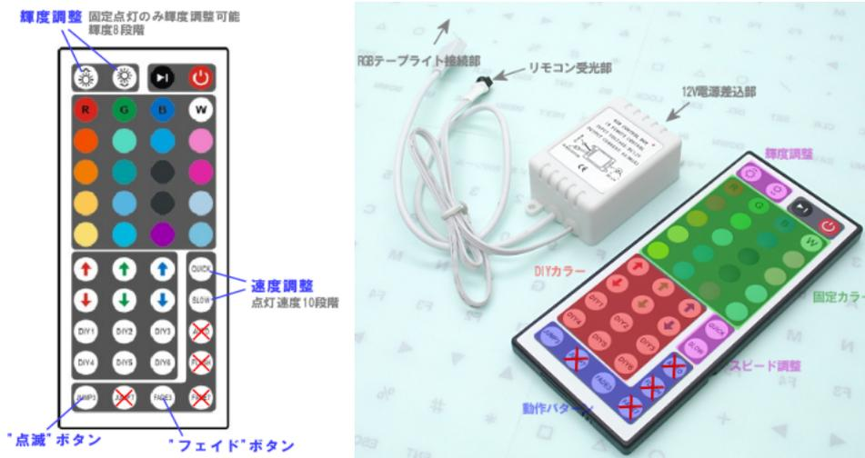
1. リモコンで点灯させる固定色(固定カラー、DIYカラー)のボタンを押します。
